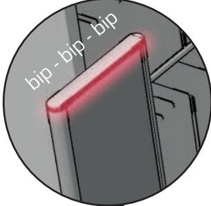
Se pueden usar diferentes secuencias de sonido para identificar automáticamente el lugar de donde proviene la alarma.
